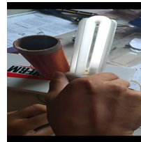
Figura 2. A lâmpada acesa por indução.
